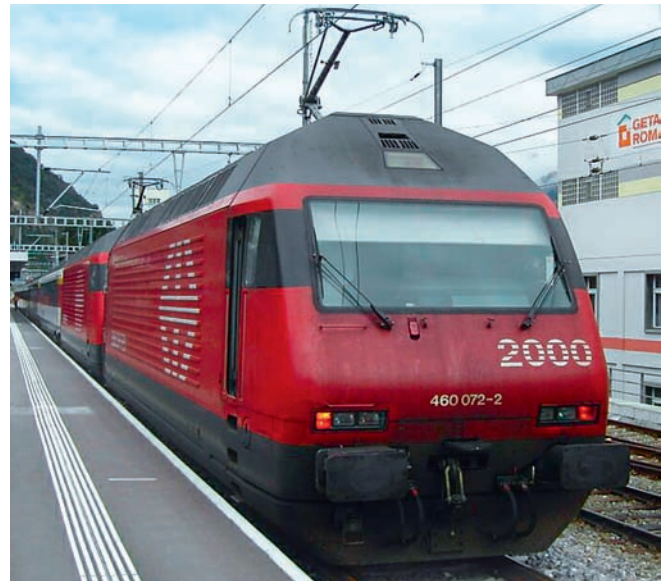
Bild 5: Messzug mit einer Lokomotive der Baureihe Re 460 mit Faiveley-Stromabnehmer und SBB-Messwagen im Bahnhof Brig.
