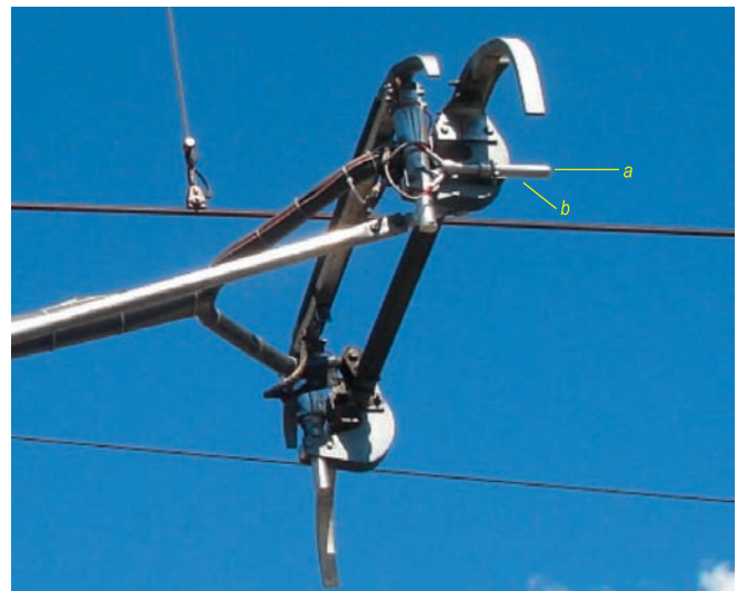
Bild 6: Prandtlsonde am Stromabnehmer mit (a) Druckbohrung am Sondenkopf zur Ermittlung des Totaldruckes und (b) Druckbohrung am Sondenschaft zur Ermittlung des statischen Druckes.
