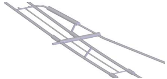
Abbildung 9: Interventionsstelle im Basistunnel Lyon-Turin
