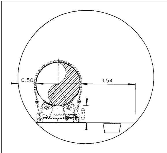
Stollenquerschnitt (Durchmesser 3800 mm) mit Gasleitung; Einheiten in m
