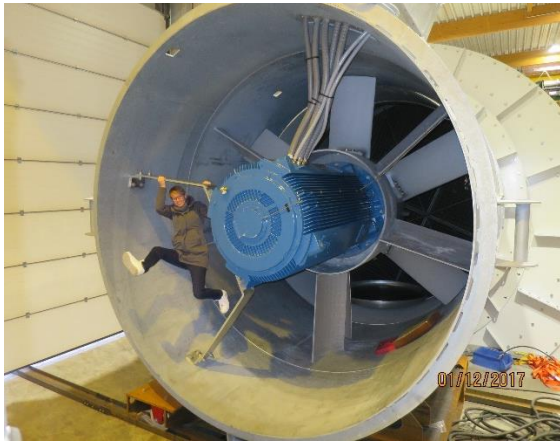
Werkabnahme eines Axialventilators
