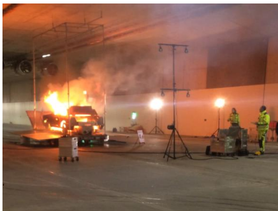
Brandversuch zur Verifikation der Luftströmungs- und Rauchausbreitungsgeschwindigkeiten
