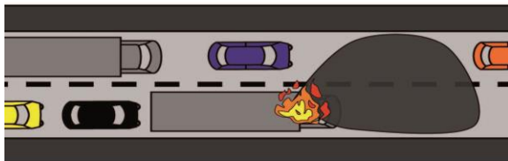
Szenario Brand in einem Richtungsverkehrstunnel
