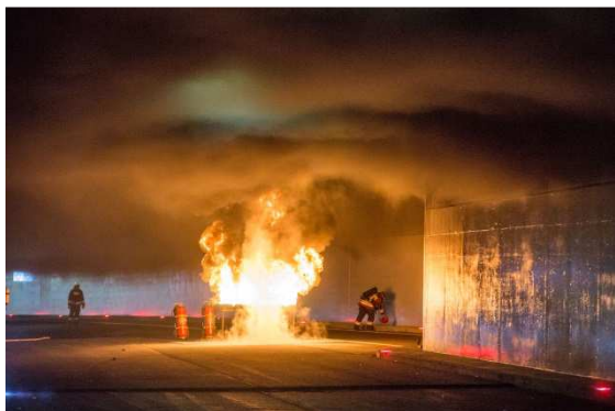
Brandversuch vor Inbetriebsetzung des ersten Bauabschnitts
