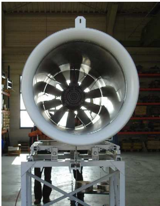
Werkabnahme der Strahlventilatoren
