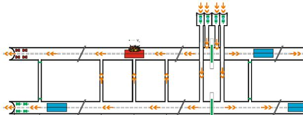
Lüftungskonzept mit Ventilatorenzentrale und Bahntunnelportalen an Tunnelschacht sowie portalnahen Strahlventilatoren bei 35 km langen Tunnel
