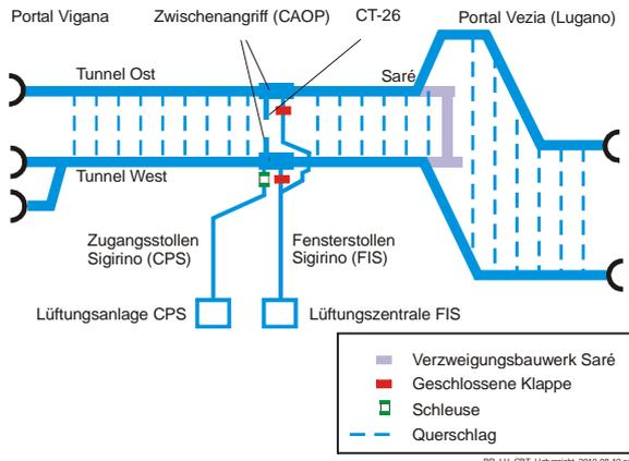
Schema des Ceneri-Basistunnels; Zwei Einspurtunnel (Tunnel Ost und Tunnel West); Der Fensterstollen Sigirino (FIS) dient als Zu- und Abluftstollen.
