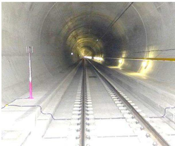
3D-Strömungsmesssystem auf Seitenweg zur Strömungserfassung bei Zugvorbeifahrten
