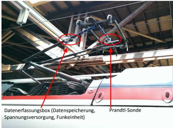
Datenerfassungsbox (Datenspeicherung, Spannungsversorgung, Funkeinheit) Prandtl-Sonde
